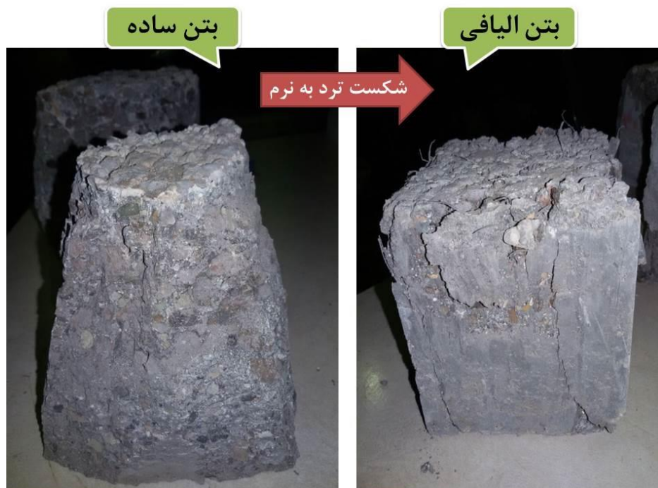
شکل ۷: گسیختگی نمونه شاهد بدون الیاف بصورت ترد و نمونه های الیافی بصورت نرم در آزمایش فشاری
