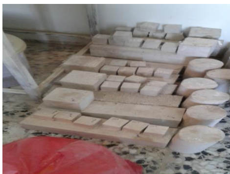
شکل ۳ - نمونه‌های ساخته شده بتن ژئوپلیمری الیافی بر پایه مناکولن
